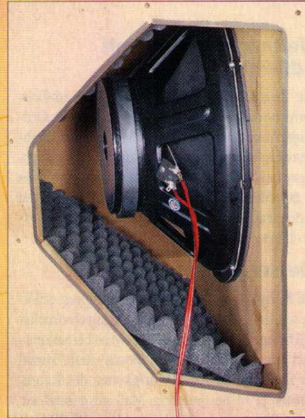
Bei abgenommenem Deckel der Tieftöner-Montageöffnung auf der Seitenwand des Horns wird der Tieftontreiber sichtbar. Zwar sind einige Verrenkungen erforderlich, um ihn zu montieren oder zu demontieren, aber immerhin gelingt es.
