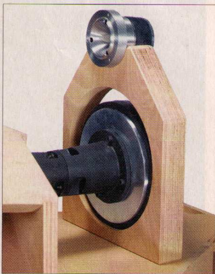
Der Hochtöner liegt frei zugänglich auf einer Halterung aus 40 bis 50 Millimeter starkem Multiplex oder MDF (Teil Nr. 18). Der Treiber des Mitteltonhorns ruht darunter in einem großen Kreisabschnitt dieser Halterung.
