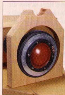
Art of Sound entfernte die rückwärtige Abdeckung des Mitteltontreibers, die hinter der Membran ein kleines Luftvolumen bildet. So ließ sich die Resonanzfrequenz des Treibers noch ein Stück absenken. Für den rauen PA-Betrieb wäre diese Maßnahme nicht ratsam, während sie für den HiFi-Einsatz nicht zu beanstanden ist.
