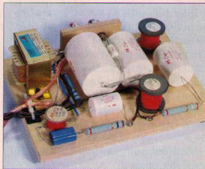
Die Frequenzweiche ist schon in der Standard-Version mit hochwertigen MKP-Kondensatoren bestückt. Die preiswerten Ferritkern-Spulen sowie die kleine Trafokernspule weichen in der High-End-Variante hochwertigen Bauteilen.
